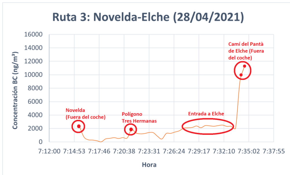
Figura 18. Representación gráfica de las concentraciones de BC captadas por el etalómetro respecto a la hora de medida en el trayecto de Novelda a Elche en vehículo el 28 de abril de 2021.
