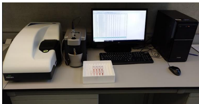
Imagen 2. Banco de trabajo con DLS (dispersión dinámica de la luz) modelo Zetasizer Nano ZS de Malvern Panalytical.
