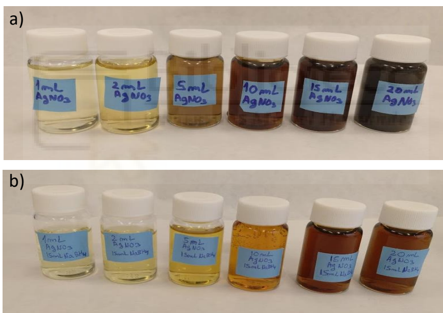
Imagen 8. Disoluciones obtenidas tras la síntesis de AgNPs a partir de un volumen constante de \text{NaBH}_4 (0,002 M): 20 mL (a) y 15 mL (b), aumentando el volumen de \text{AgNO}_3 (0,001M).
