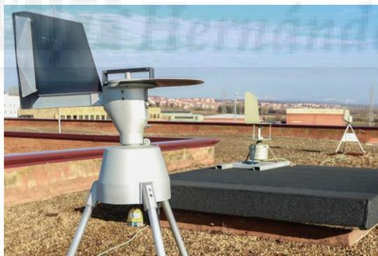
*Figura 1. Imagen del captador volumétrico tipo Hirst.*
