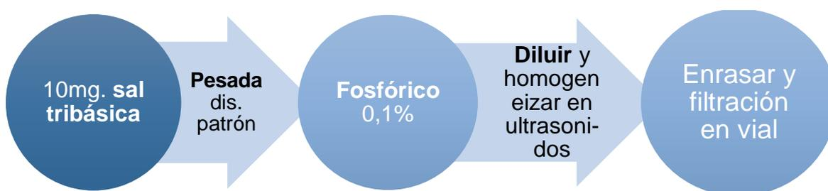
**Figura 7.** Paso 2: Preparación de la disolución de referencia (disolución patrón).
