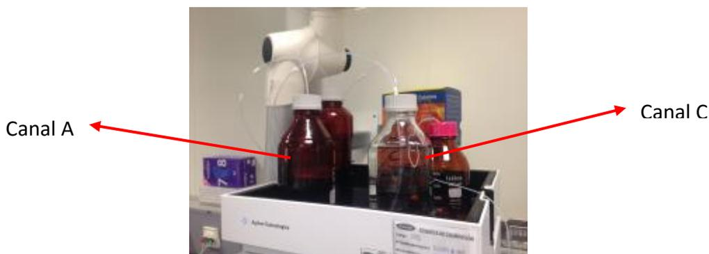
**Figura 5.** Reactivos A (ácido fosfórico 0,1%) y C (acetonitrilo), colocados en el cromatógrafo.
