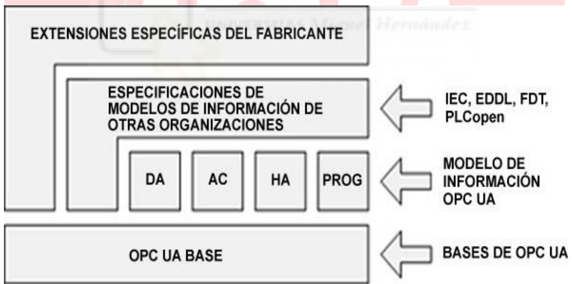
Ilustración 35. Capas de la arquitectura OPC UA
