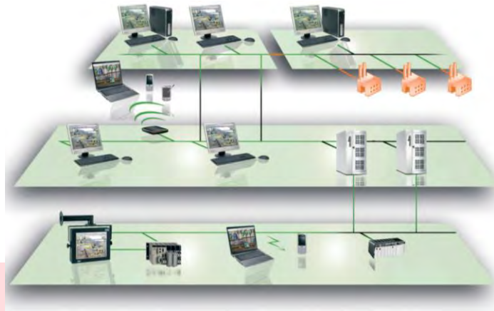
Ilustración 38. Arquitectura distribuida (Topkapi)
