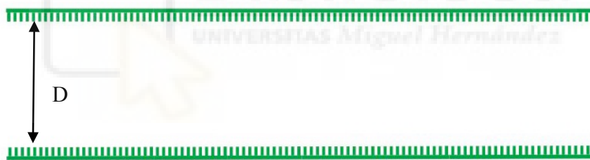
Figura 2.7. Representación esquemática de la guía hueca plana propuesta como guía de bajas pérdidas para frecuencias de THz.
