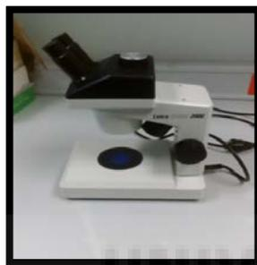
**Figura 10:** lupa binocular con doble luz incidente.
