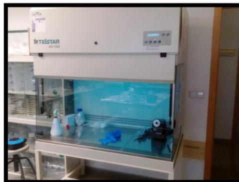
**Figura 7:** campana de flujo vertical, con luz ultravioleta en marcha
