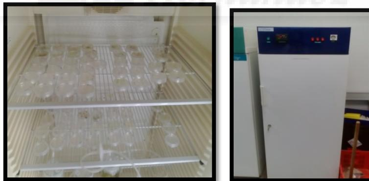
**Figura 8 y 9:** Placas Petri como cultivo situadas en las bandejas de la cámara. A la derecha la cámara de crecimiento utilizada tipo GROW.
