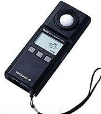
Figura 4: Luxómetro utilizado.
