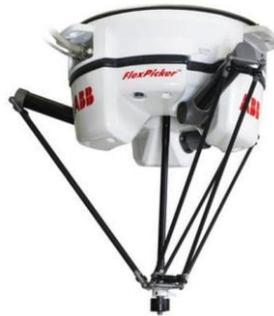
5. Robot paralelo (fuente: [www.abb.com](http://www.abb.com))
