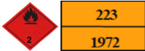
Ilustración 2. Paneles identificativos de riesgo asociados al GNL
