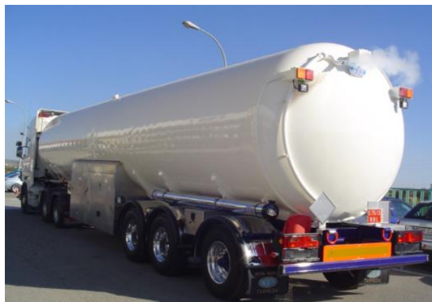
Ilustración 1. Cisterna de GNL
