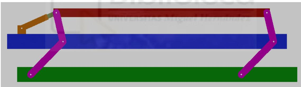
Una vez colocado el cilindro, aparece una duda respecto al comportamiento del mecanismo, ya que comienzo a imaginar cómo reaccionaría la barra que une en la parte superior a las dos bielas, cuando el remolque está cargado y empieza a elevarse la plataforma.
