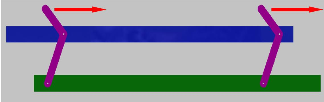
Con la modificación de las bielas ya existe un punto de apoyo donde se puede aplicar una fuerza que permita el movimiento del mecanismo
