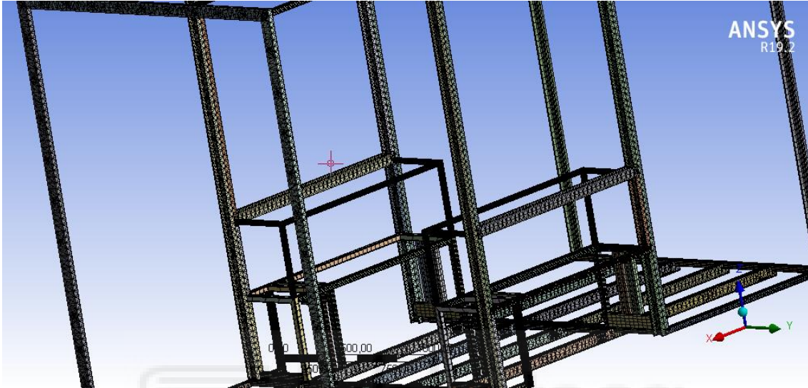
Figura 2.12: Mayado de la estructura con perfiles tipo C
