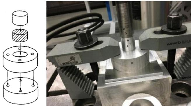
Ilustración 69: Útiles para ensayo de compresión confinada. Peng, S. H (1994); Amstutz, C (2018)
