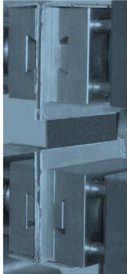
Ilustración 31: Probeta de cizalladura pura. Sasso, M (2008)
