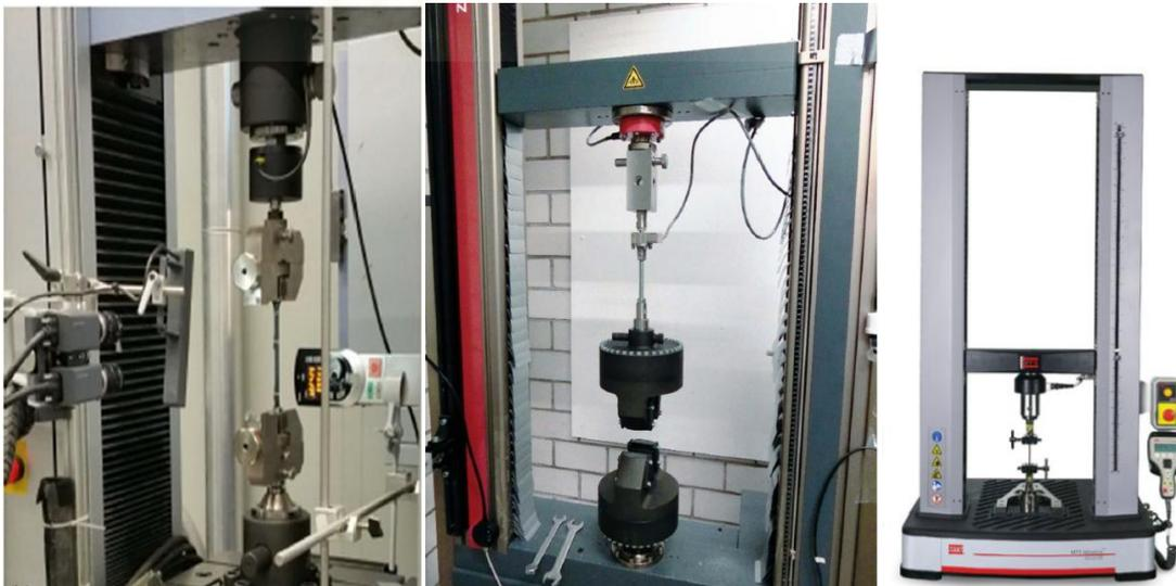
Ilustración 54: Diferentes máquinas de ensayo universal. Amstutz, C (2018); Staudt, Y (2018); [24]
