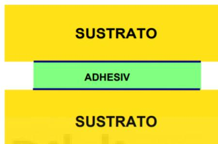
Ilustración 2: Esquema básico de unión adhesiva. [22]
