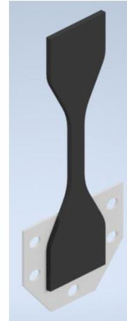
Ilustración 55: Sistema de sujeción para hueso de perro.
