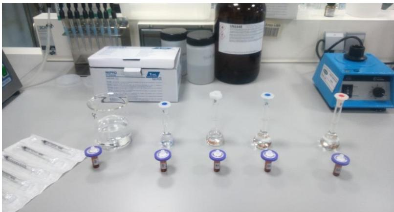
**Figura 7.** Obtención de los viales con concentraciones de 25, 10 y 5 ppm de cafeína y un blanco para la recta de calibrado. Preparados para la cromatografía
