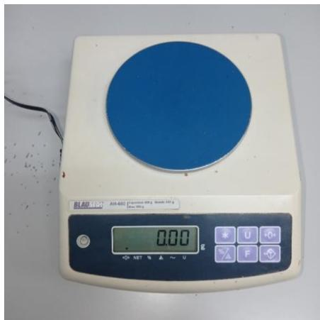
Figura 13. Detalle de la balanza (Blauscal modelo AH-600)
