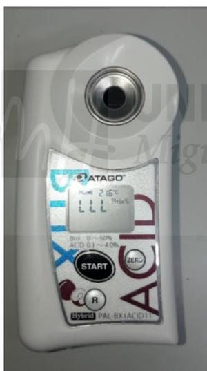
**Figura 16.** Detalle del refractómetro empleado para la medición de sólidos solubles.
