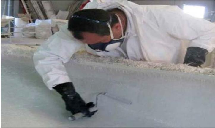
Figura 9. Extensión de resina de forma manual. Fuente: INSST. Basequim 2012<sup>25</sup>
