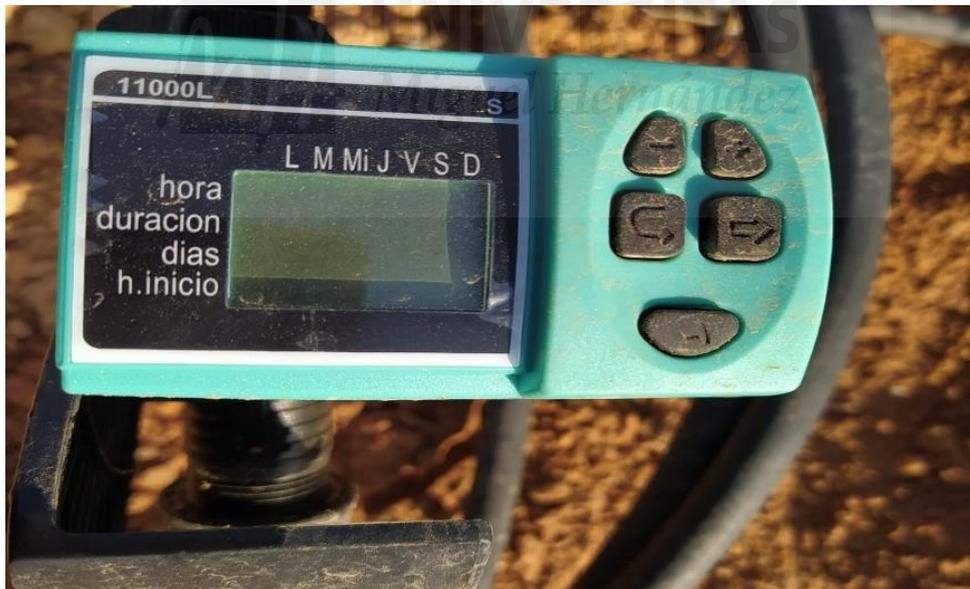
**Figura 9.** Programador de riego empleado en el ensayo de campo.
