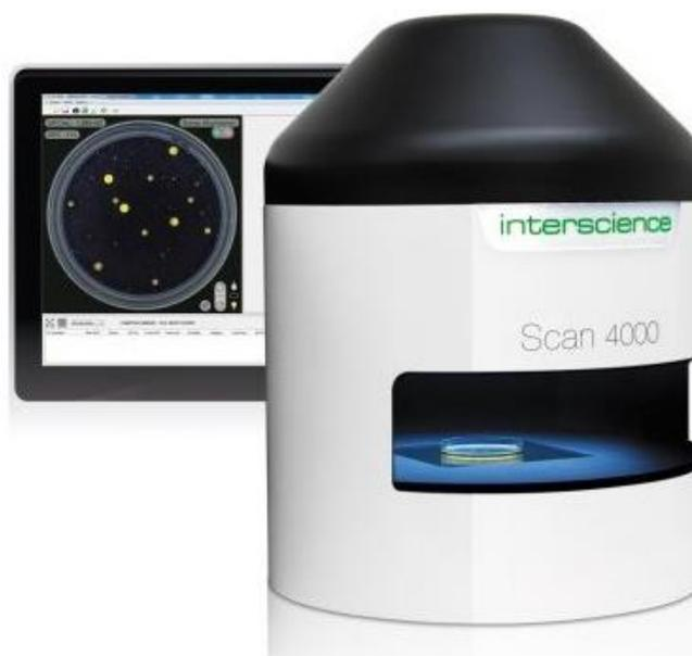
**Figura 13.** Contador de colonias automático Ultra-HD Scan 4000, versión 8.0.10.0 (*Interscience*).
