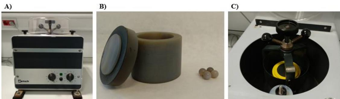
**Figura 9.** A) Molino de bolas planetario *Retsch* modelo *S1*; B) Recipiente de molienda y bolas utilizados; C) Rueda principal giratoria y espacio para el recipiente de molienda.
