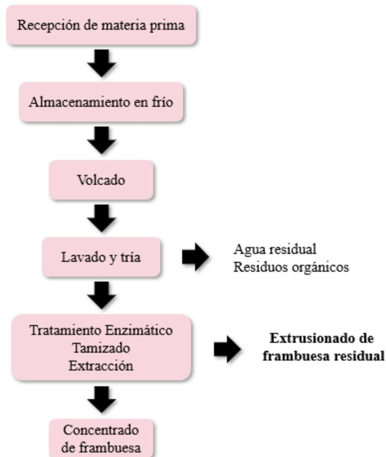
**Figura 4.** Diagrama de flujo del proceso industrial de obtención del concentrado de frambuesa (Adaptada de: HUDISA (2019)).
