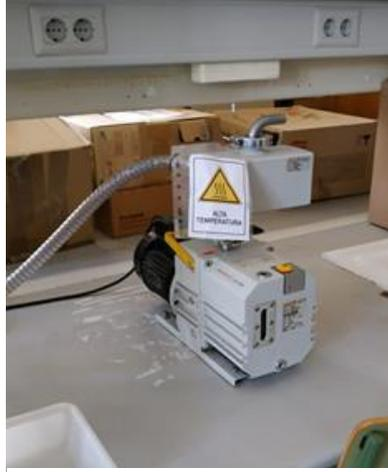
**Figura 3:** Bomba de vacío acoplada al liofilizador.
