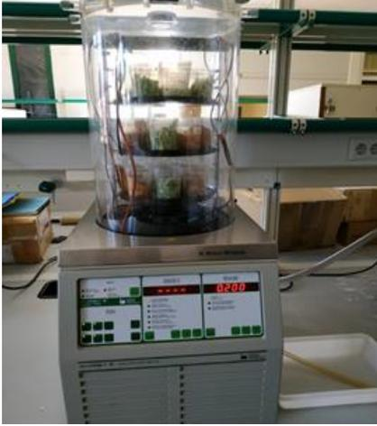
**Figura 2:** Liofilizador. Se muestra la cámara seca y condensador con circuito de refrigeración.
