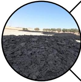
Los lodos de depuración, como señala Camacho (2009), consisten en una mezcla de agua y sólidos separada del agua residual, como resultado de procesos naturales o artificiales. Se generan como resultado de las distintas etapas en las estaciones depuradoras que reciben aguas residuales urbanas, en las fosas sépticas y en otras estaciones depuradoras de aguas residuales que traten aguas de composición similar, principalmente de la industria agroalimentaria.
