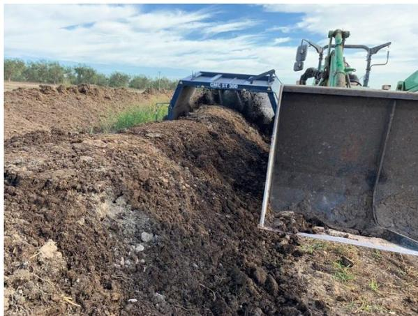
**Figura 7. Volteadora de carga utilizada para el volteo de pilas de compostaje.**
