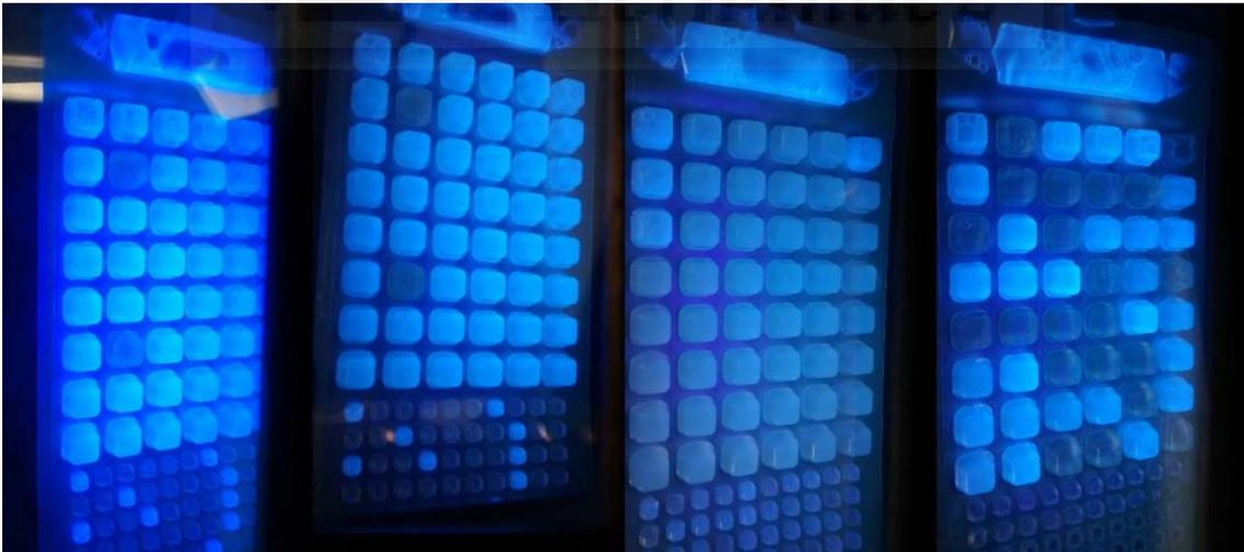
Figura 9. Blísteres Quanti-Tray®/2000 bajo luz UV mostrando diferentes grados de fluorescencia.
