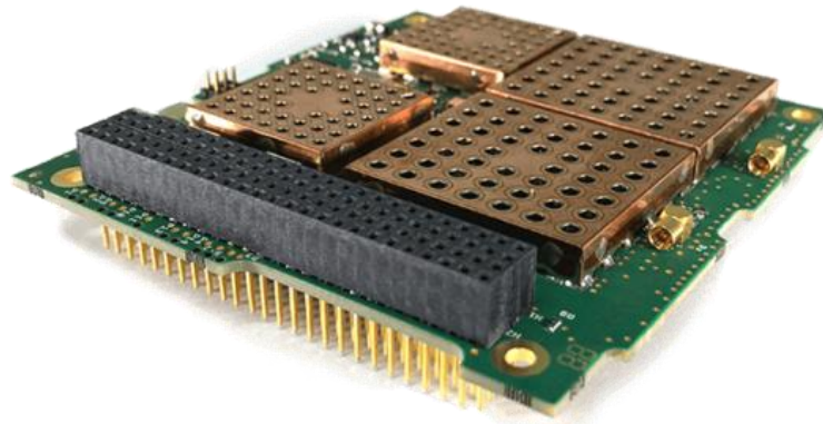
Fig. 23: Transceptor VHF/UHF destinado a telemetría [46]
