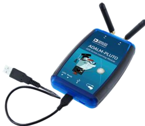
Fig. 24: Sistema de comunicación SDR ADALM-PLUTO [47]
