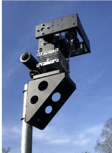
Fig. 47: Motor de control azimutal y de elevación para la estación terrena [82]
