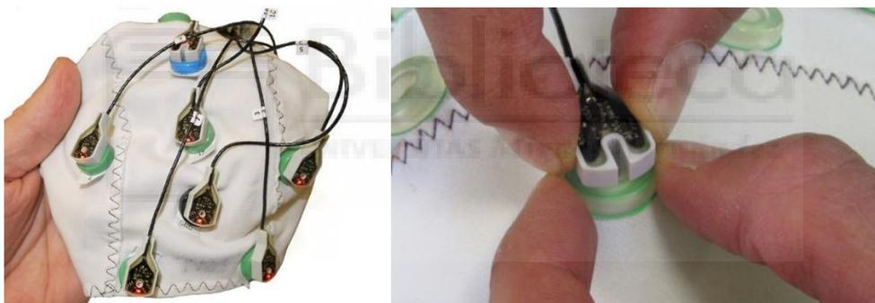
*Figura 5: Casco con malla y electrodo. Fuente [21]*
