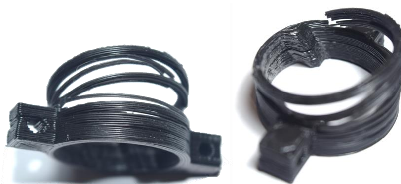
Figura 3.32: Impresión de la tuerca de una articulación helicoidal después de la calibración
