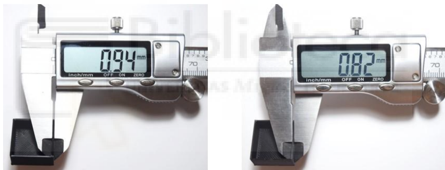
Figura 3.35: Comprobación de los grosores antes (izquierda) y después del ajuste del flujo de material a extruir (derecha)
