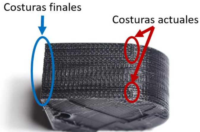
Figura 3.36: Visualización de las costuras en las piezas (rojo) y la posición nueva de las costuras (azul) tras la configuración de la alineación de costuras en Z
