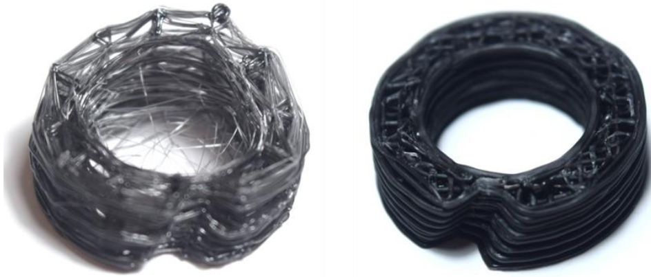
Figura 3.29: Impresiones fallidas al imprimir un cilindro de las articulaciones helicoidales
