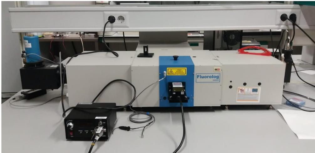
**Figura 2.5:** Fluorímetro utilizado en el laboratorio.
