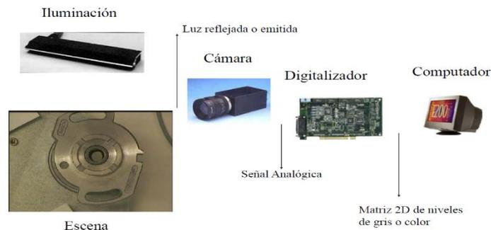
ILUSTRACIÓN 1. COMPONENTES DE UN SISTEMA DE VISIÓN POR COMPUTADOR
