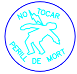
SEÑAL DE PELIGRO DE MUERTE
