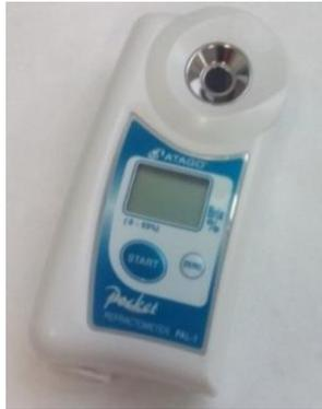
Figura 3.8. Refractómetro utilizado para medir el contenido de sólidos solubles.
