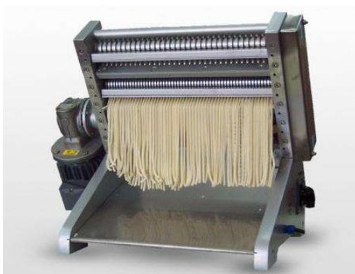
Se insiere la mezcla ya amasada en la moldeadora (*ilustración 4*) la cual da la forma al producto gracias a los diferentes moldes que se emplearán dependiendo del tipo de pasta que se quiera fabricar. Las cuchillas irán cortando de manera automática dando lugar al producto en su forma final.
