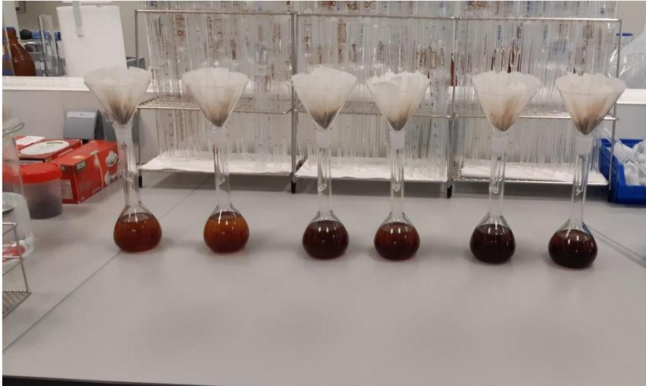
Figura 7. Matraces de 100 ml tras la tercera extracción de té Pu-Erh de los diferentes preparados comerciales.
