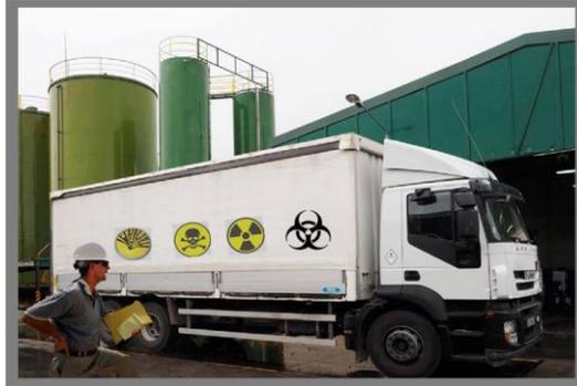
Ilustración 5 Vehículo para transporte extracentro de residuos peligrosos.
