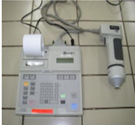
Fotografía 8: Colorímetro utilizado para medir el color.
