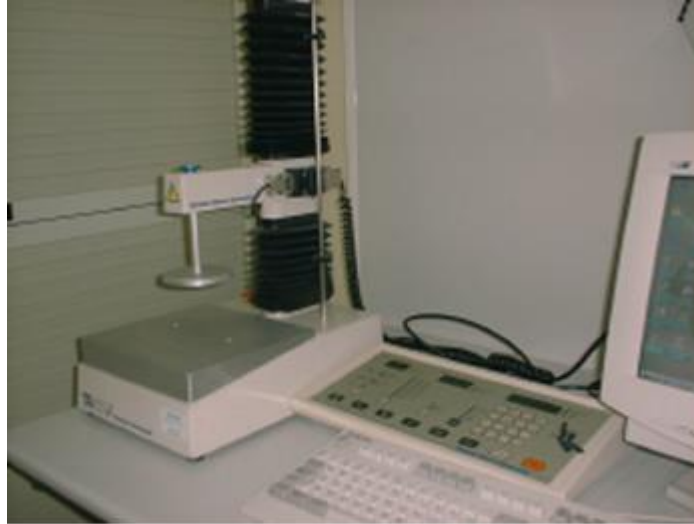
Fotografía 9: Texturómetro utilizado para medir la firmeza de los frutos.
