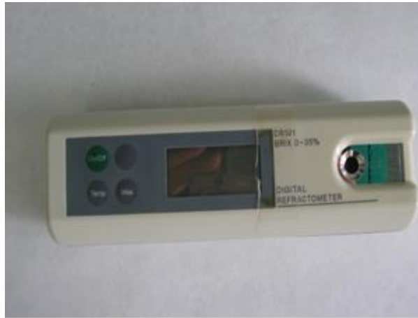
Fotografía 10: Refractómetro utilizado para medir los °Brix (SST).
