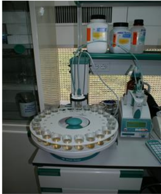
Fotografía 11: Valorador automático Methrom, utilizado para determinar la acidez.
