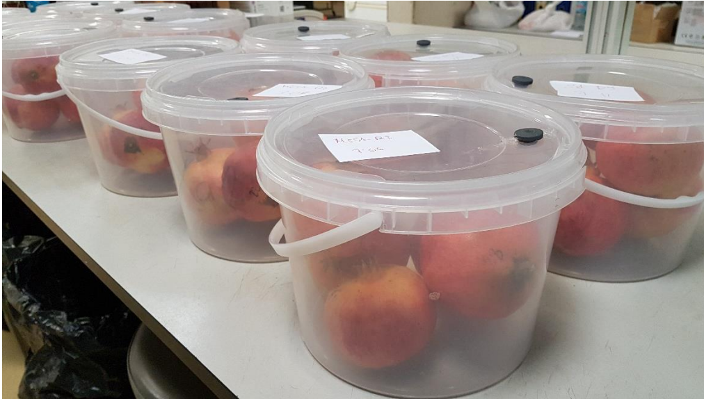
fotografía 3. Recipientes herméticos para la determinación de la tasa de respiración y producción de etileno.
