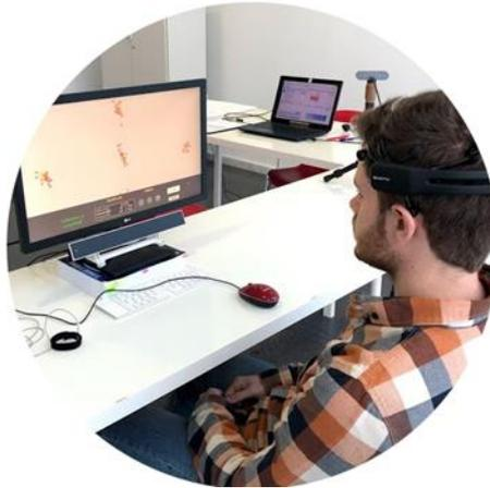
**Ilustración 13. Sujeto durante la calibración del Eye-tracker. También se observa la diadema EEG.**
