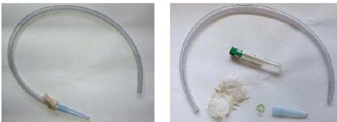
Figura 15. Izquierda: aspirador entomológico manual. Derecha: aspirador entomológico manual con sus partes y tubo de muestras.
