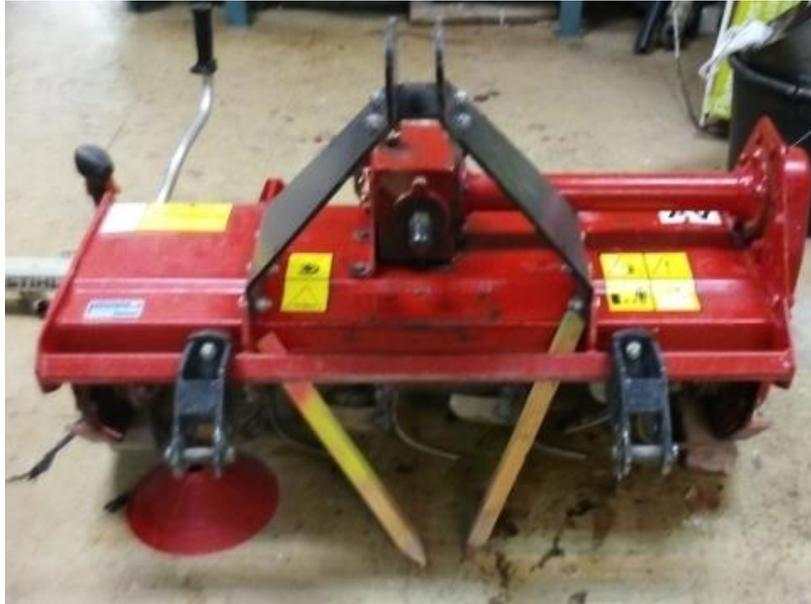
Figura 9. Fresadora con cuchillas curvadas.
