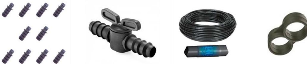
Figura 11. De izquierda a derecha: salida directa 8x16; válvula de PE de 16 mm; tubería de PE con gotero integrado de 16 mm de diámetro; anilla final para tubo de PE de 16 mm.
