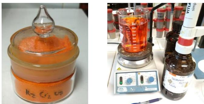
**Figura 3.9.** Disolución de dicromato de potasio utilizada para valorar el carbono oxidable.
