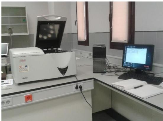
Figura 4. Espectrómetro ARL Quant'x (Thermo Fisher Scientific, UK).
