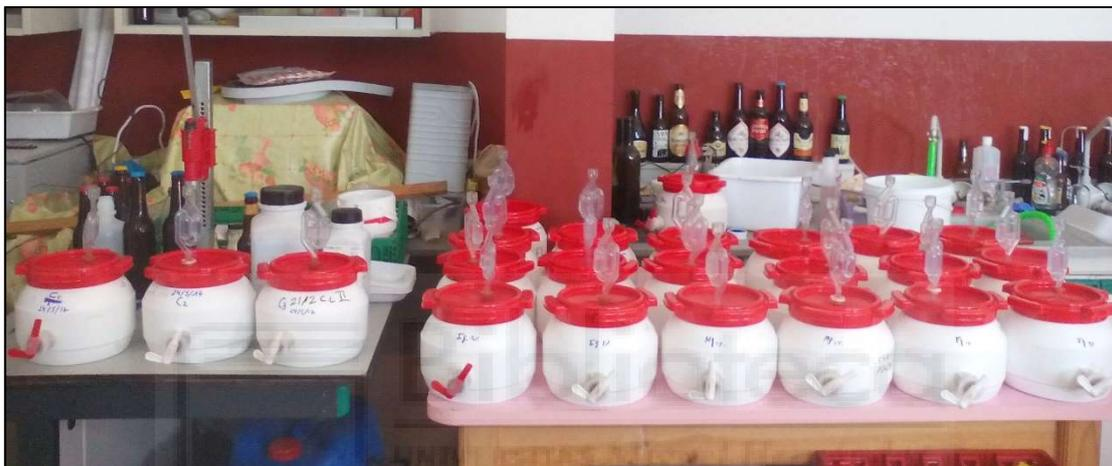
**Fig. 25. Fermentadores de plástico con tapa de rosca y “Airlock” utilizados. Instalaciones de la UMH en la EPSO.**
