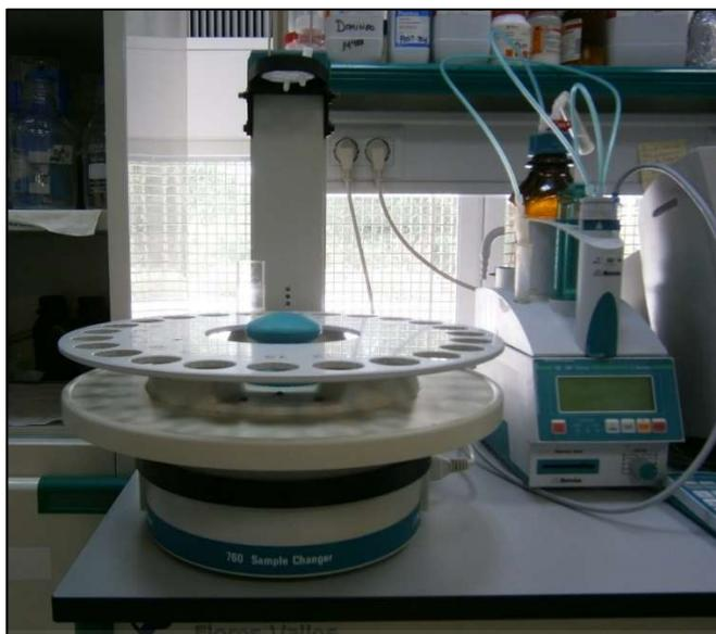
Fig. 27. Equipo empleado en la determinación de la acidez. Metrohm 760 Sample Changer.
