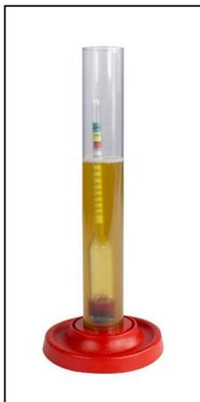
Fig. 26. Densímetro similar al empleado para determinar la densidad del mosto cervecero.
