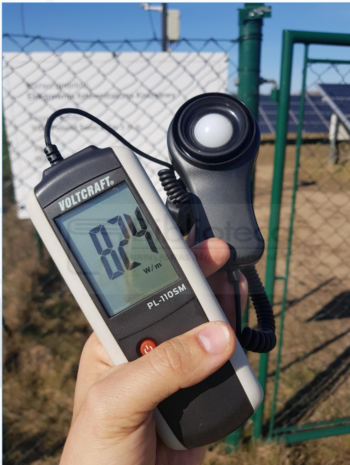
*\* zdjęcie potwierdzające pomiar nasłonecznienia w dniu wykonywania lotów termowizyjnych, wersja oryginalna z danymi EXIF oraz GPS potwierdzającymi datę, godzinę oraz miejsce wykonania dołączona jest do każdego raportu*
