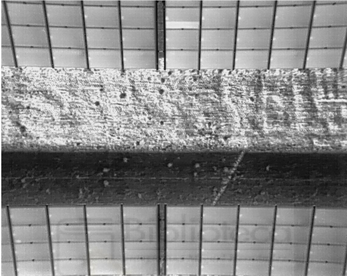
Figure 4.2: Ejemplo termografía aérea. Como se puede apreciar un bypass en el *string* superior derecho lo que nos indica que alguna célula de la subcadena dentro del módulo está dañada
