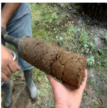
Figura 1: Barreno (instrumento para la extracción de la muestra de raíces.)
