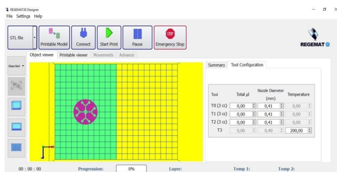
Figura 5. Pantalla principal del programa Regemat 3D Designer. En la zona verde se observa la estructura en el área de impresión.
