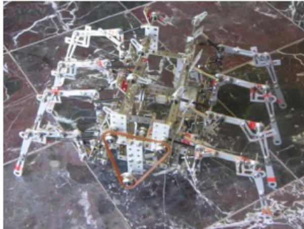
FIGURA 2.1: Robot octópodo de Soyguder y Alli, 2011
