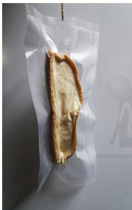
Fig. 8. Detalle proceso de producción vacío y sellado
