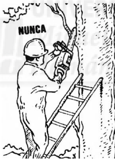
FIG. 8: No utilizar la motosierra sobre lugares inestables.
