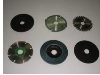
FIG. 17: Discos de radial, para diferentes materiales. Fuente: Imagen 4 Anexo2
