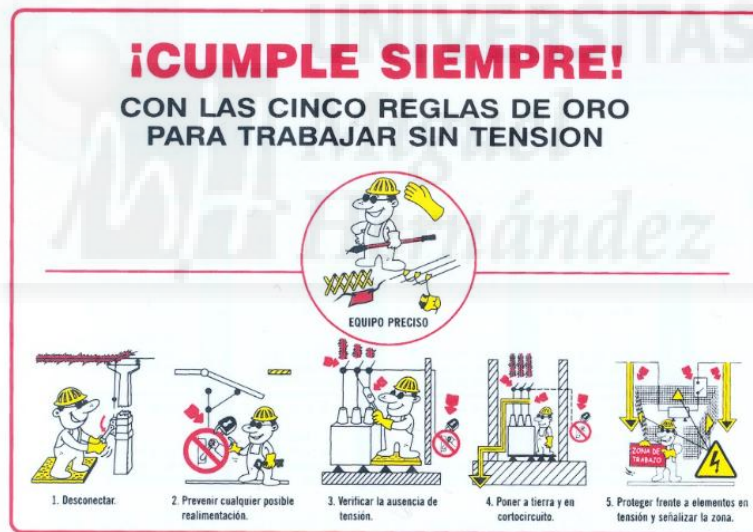
FIG. 32: Reglas de oro para trabajos en tensión.
