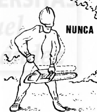
FIG.6: Forma incorrecta de arrancar una motosierra.
