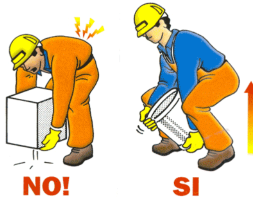
FIG. 23: Forma adecuada para levantar una carga.
