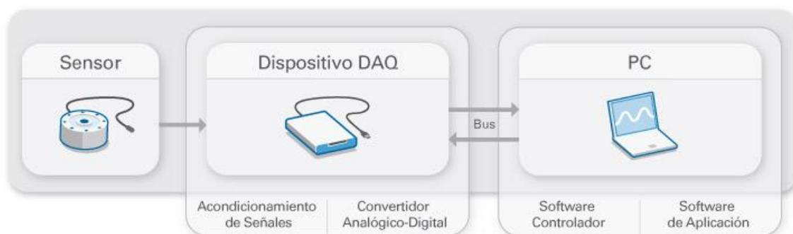
**Figura 24. Sistema de Adquisición de datos.**
