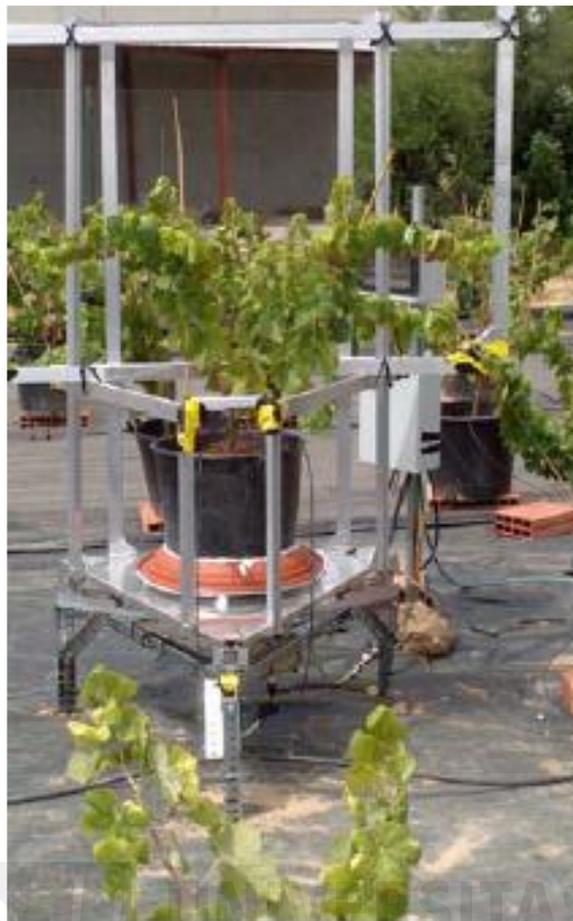
**Figura 13: Instalación del lisímetro en campo**
