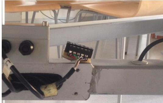
**Figura 23. Conversor de 4 a 6 hilos.**
