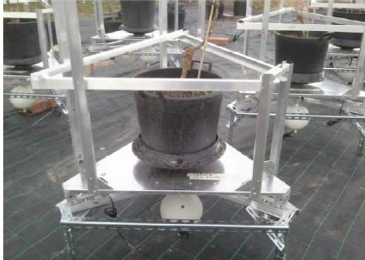
**Figura 2: Lisímetro de Pesada Vertical**
