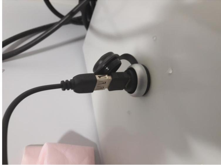
Figura 67. Pasamuros USB instalado.
