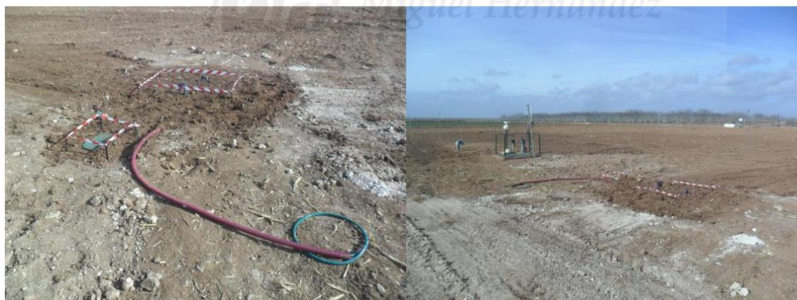
Figura 36. El equipo de lisimetría LISITN AC-E1 completamente instalado y señalizado para evitar que el tractor trabaje en esta zona. Al fondo se aprecia la estación lisimétrica del ITAP que se utilizará para validar el prototipo LISITN AC-E1.
