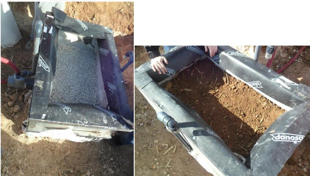
Figura 29. Equipo de lisimetría LISITN AC-E1 con la grava en el fondo del recipiente de cultivo y durante el proceso de relleno.
