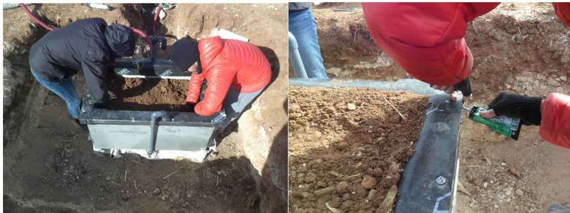
Figura 30. Equipo de lisimetría LISITN AC-E1 durante el proceso de relleno y el sellado de la lámina para evitar la entrada de tierra.
