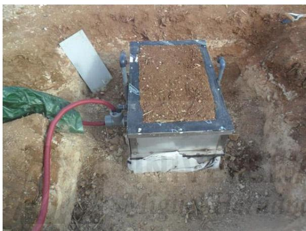
Figura 31. Equipo de lisimetría LISITN AC-E1 antes de proceder al relleno de la excavación.
