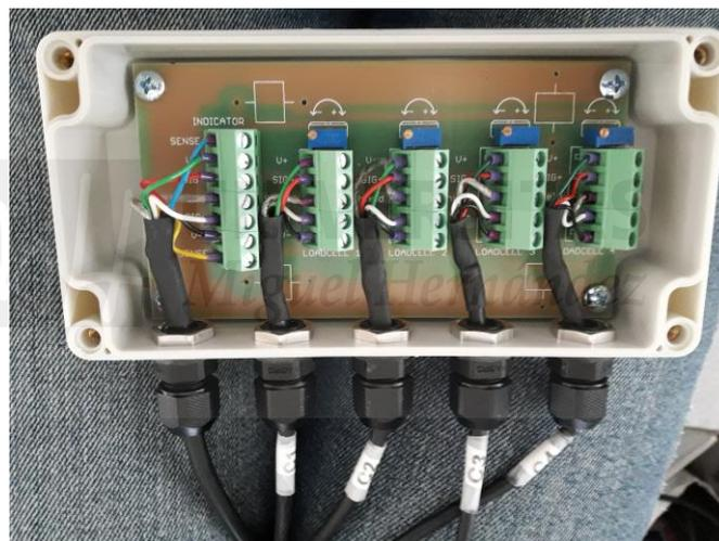
Figura 24. Sumador electrónico de 4 células.
