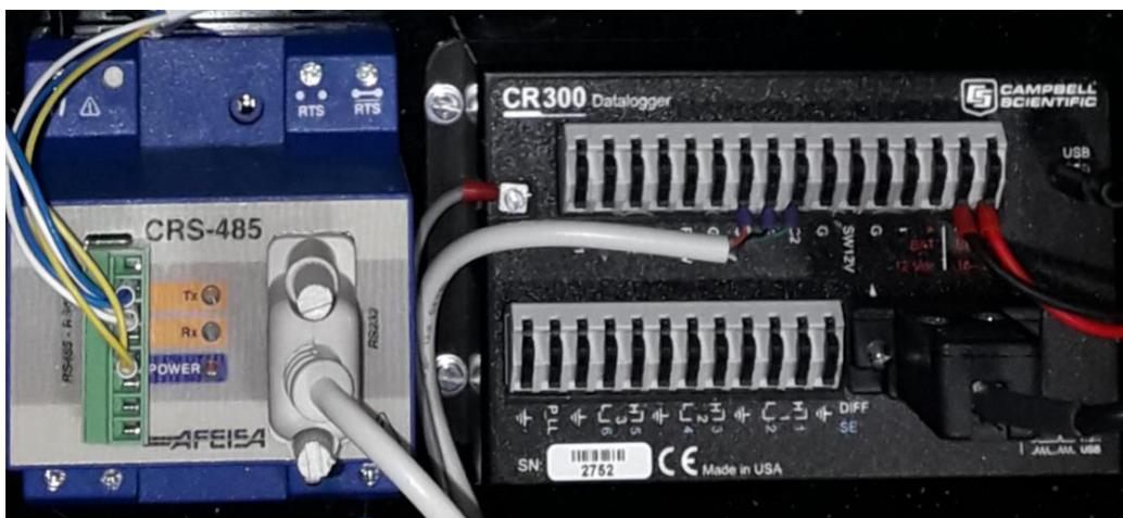
Figura 34. Bus MODBUS conectado al CRS-485 y conexión puerto serie del CR300.
