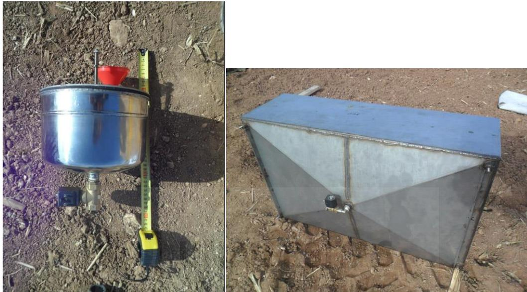
Figura 20. Depósito de drenaje y recipiente de cultivo.
