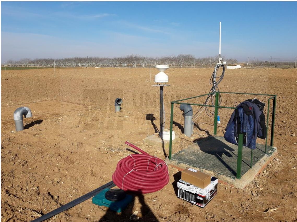
Figura 110. Vista exterior del lisímetro de referencia.
