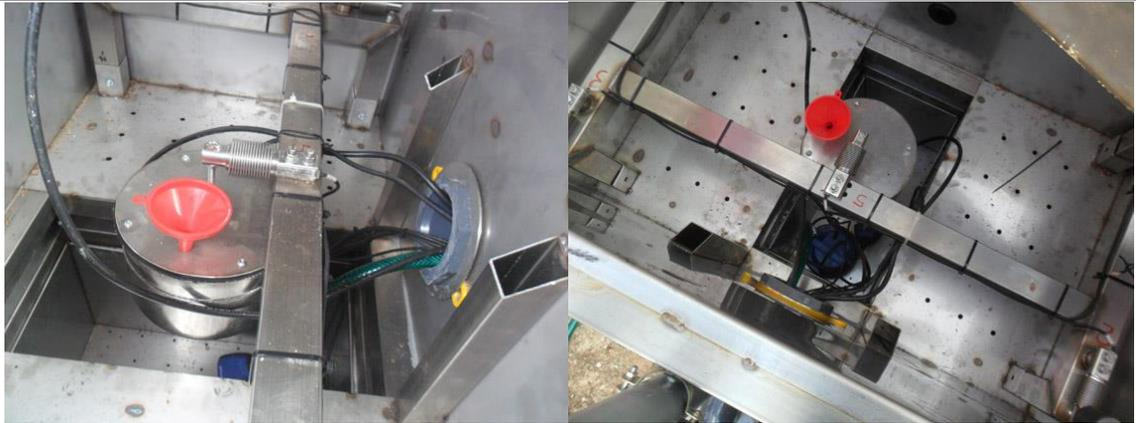
Figura 24. El cableado interior se fija mediante bridas para evitar el contacto con las células de carga y el depósito de drenaje.
