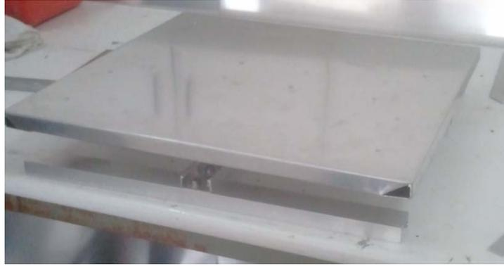
Figura 2-4, Modelo con una sola célula de carga
