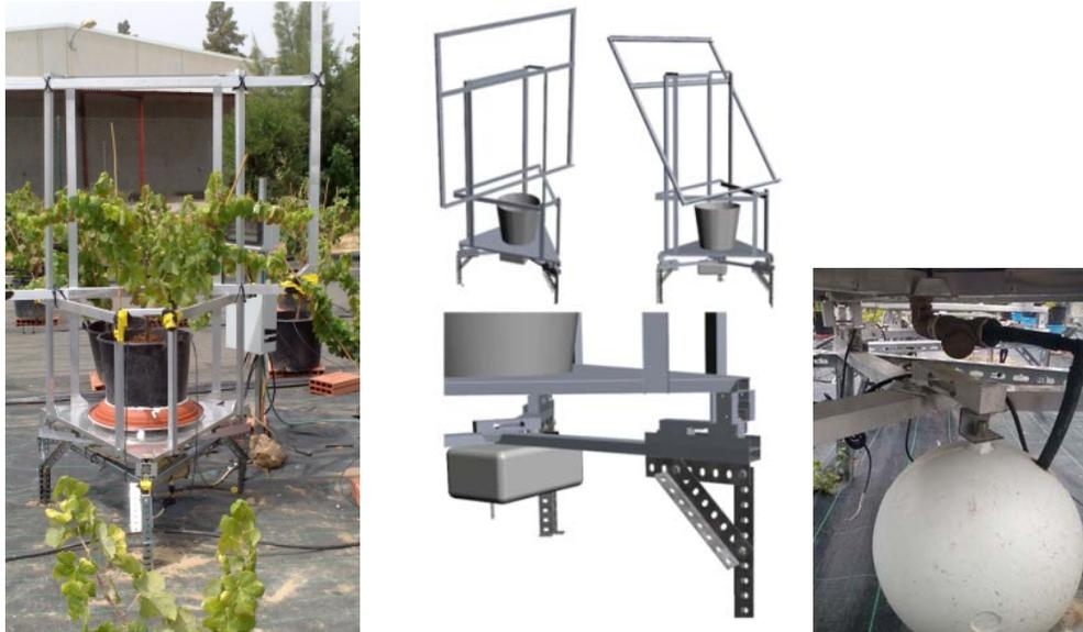
Figura 2-8. Estructura e instalación del dispositivo de medida. A la izquierda se muestra la instalación de un dispositivo. En el centro el modelo 3D. A la derecha el detalle de un depósito de drenaje y su célula de carga.
