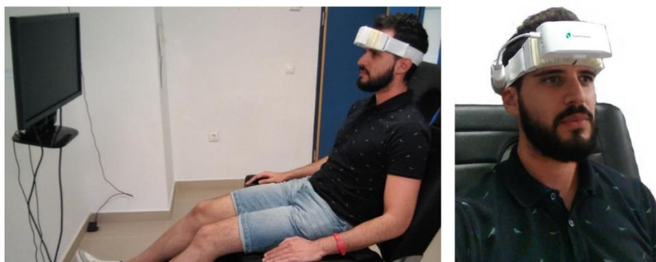
*Figura 3.* Izquierda: disposición física del participante y el monitor durante la realización del experimento. Derecha: espectroscopio de luz cercana al infrarrojo colocado a 1 cm. de la línea fronto-polar.
