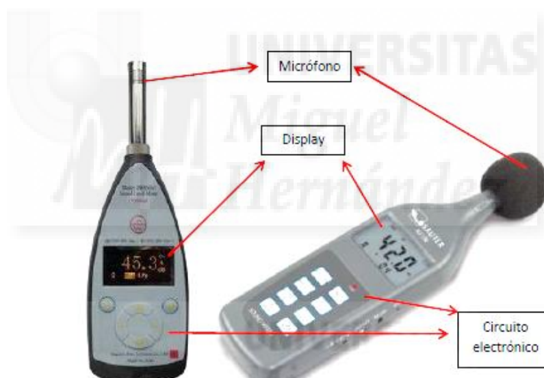
Figura 1. Sonómetro de clase 1 (izquierda) y sonómetro de clase 2 (derecha)
