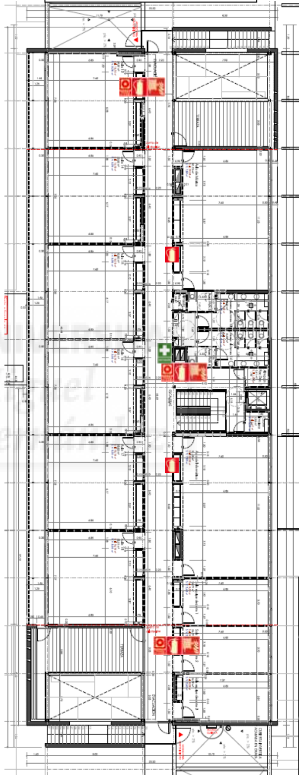
IMAGEN 44: Plano Bloque 3, Planta Primera, BIE, pulsador, extintores y botiquines
